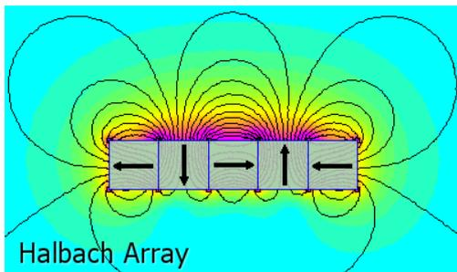
Figure 4. Halbach array scheme [9].
