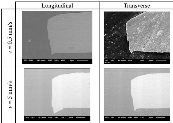
TABLE VIII. THE SHEAR EDGE OF COPPER BLANKING-PART
